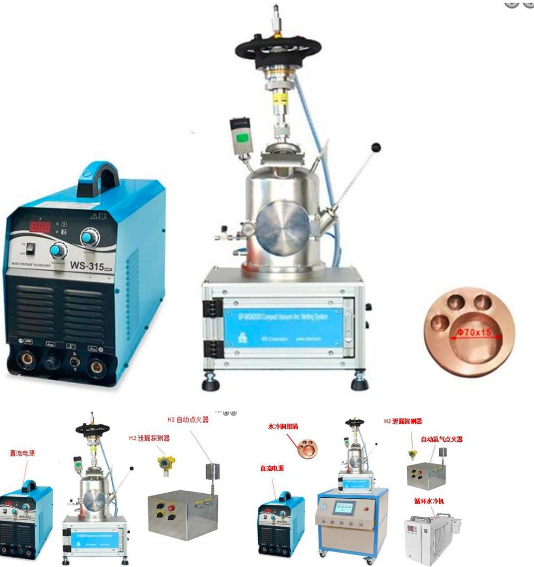
SP-MSM200 是一款小型真空电弧熔炼炉，配置水冷铜坩埚，最大熔炼量可达 200g(Fe).设备上安装有一机械操作手，可在熔炼过程中翻转样品。此电弧炉也可用作氢气等离子体电弧熔炼炉
