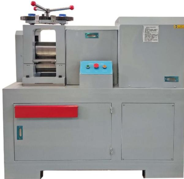
MSK-5070-AC 是一款大功率金属冷轧机，功率可达 5.5KW，轧辊材质采用Cr<sub>12</sub>MoV 合金，辊轧样品硬度 HRC<50，最大放样厚度可达 20mm。
