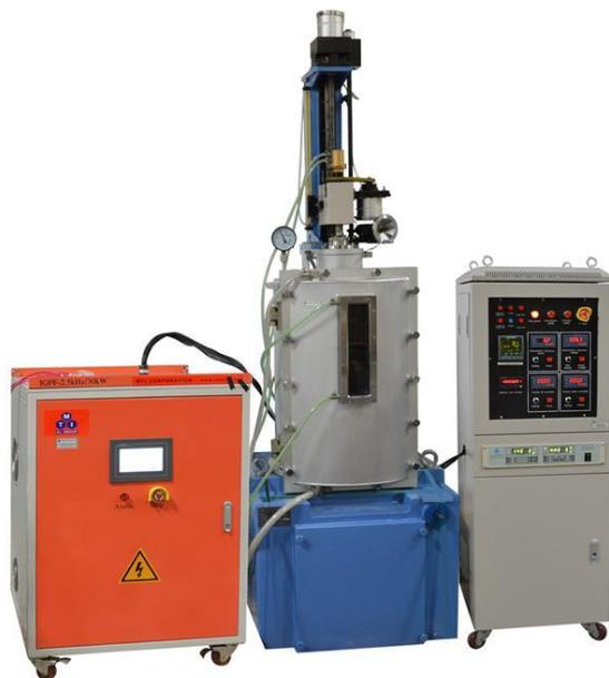
SKJ-50CZ 是一款高质量的 CZ 晶体生长炉，可针对材料的实验探索，也可以适用于晶体材料的生产。此款晶体生长炉已经被证实可以提拉各种氧化物单晶和金属单晶，如蓝宝石、GGG, YAG, LaAlO<sub>3</sub>, Si 和 Ge 等，最高温度可达 2100℃，最大可长出晶体尺寸为 2 英寸。技术参数（图片仅供参考，以最终实物为准）
